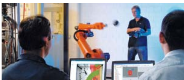
SafetyEYE umožňuje bezpečnou spolupráci člověka se strojem.
